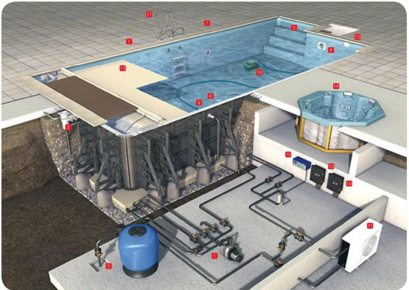
**1. Pompa di filtrazione con prefiltro**
